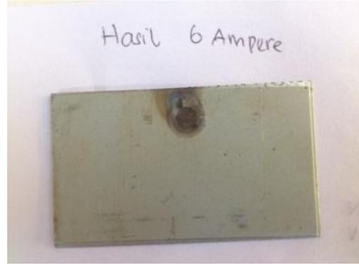
Gambar 4.3 Hasil pengelasan 6 Ampere
