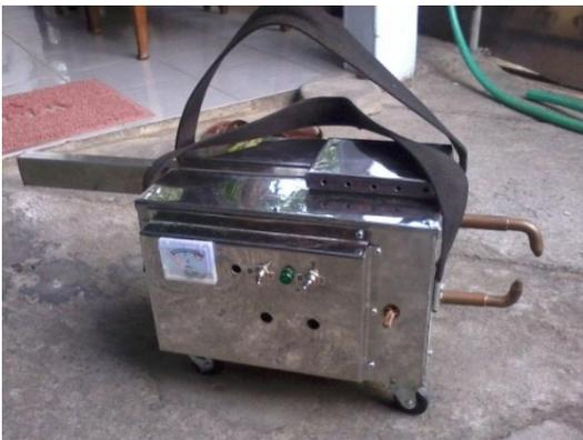
Gambar 4.2 Mesin las titik hasil rancangan
