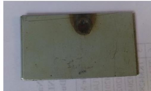
Gambar 4.4 Hasil pengelasan 8,6 Ampere
