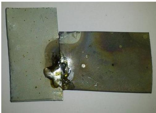
Gambar 4.6 Hasil pengelasan brazing 8,6 Ampere
